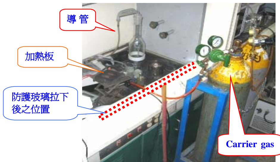
圖一 實驗台配置圖
