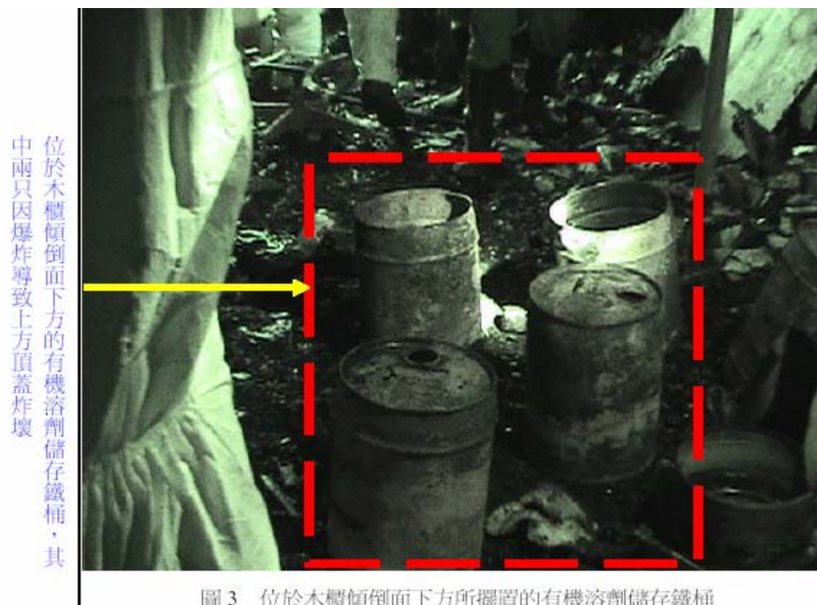
圖 3 位於木櫃傾倒面下方所擺置的有機溶劑儲存鐵桶
