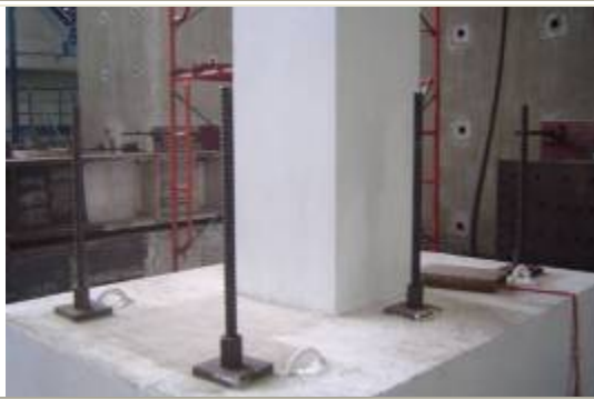
預力鋼棒突出段應加護套
