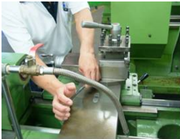
正確鬆開螺絲鉋手方式
