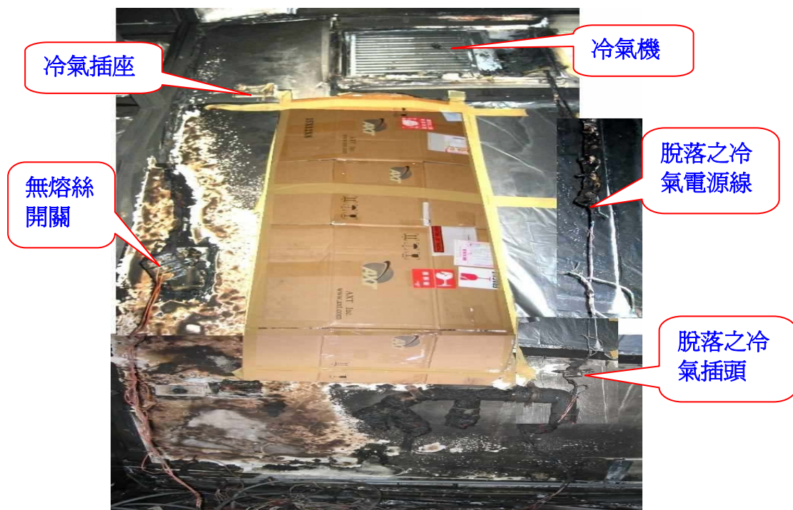
圖一 內牆電氣線路配置情形
