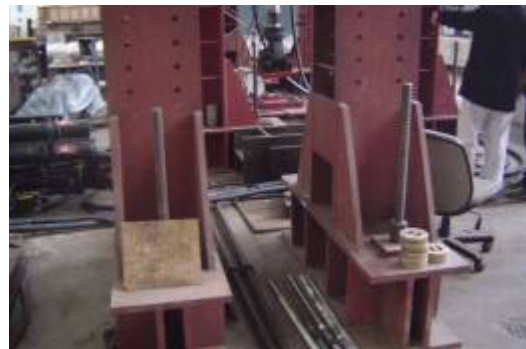
預力鋼棒突出段應加護套
